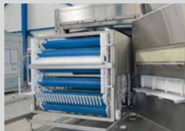
Der CBF ist durch die herausfahrbare Transporttechnik ideal zu reinigen
